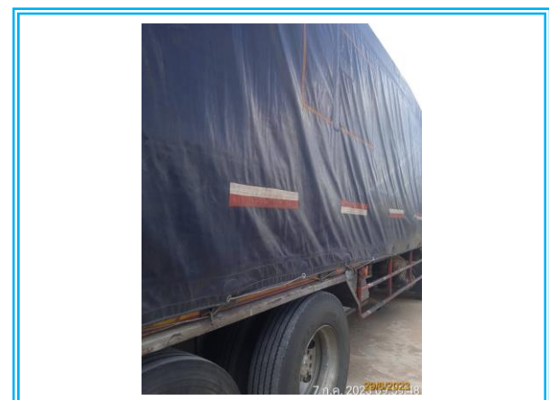
รูปที่ 3.1-18 รถขนส่งวัสดุก่อสร้างที่มีการปิดคลุม
