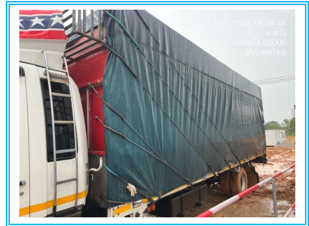
รูปที่ 3.1-14 ปิดคลุมรถบรรทุกขนส่งวัสดุอุปกรณ์ก่อสร้าง อย่างมิดชิด
